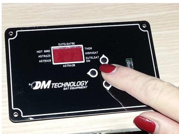
( questa procedura è da eseguire solo la prima volta, e serve a selezionare un altro satellite, poi in seguito, l'antenna si potrà avviare come sempre premendo solo il pulsante verde ). Ora l'antenna partirà, e punterà in modo automatico questo satellite. Una volta che sul pannello di controllo, compare la scritta SP ( sat puntato ), per vedere Il satellite HotBird, è sufficiente premere 3 / 4 volte il pulsante freccia dx
